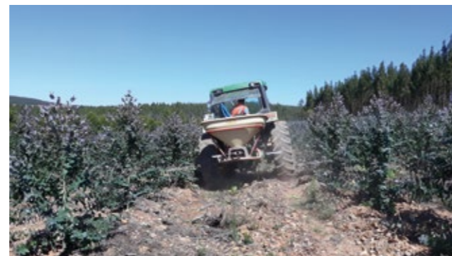
▼ Fig. 1 - Distribuidor de adubo pendular a adubar em bandas, na área de projeção da copa das árvores (nas linhas de plantação)
