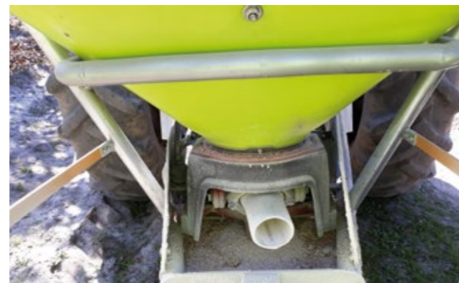
► Fig. 2 - Pêndulo Nylon de 200 mm (cortado do anterior), para adubação em bandas ou faixas com cerca de 2 m de largura, ao longo das linhas de plantação
