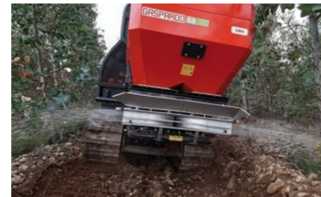
◀ Fig. 4 - Distribuidor de discos para adubação em bandas (nas linhas de plantação) e para a generalidade da área (retirando as abas metálicas traseiras)
