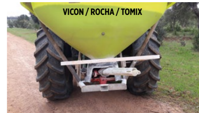
▼ Fig. 3 - Pêndulo Nylon de 500 mm, com difusor na extremidade, para adubação na área total, até 12 m de largura de trabalho
