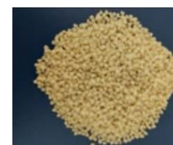
◀ Pellets de compósito (pó de celulose + plástico) para alimentar as máquinas de injeção que produzirão os tubetes.
